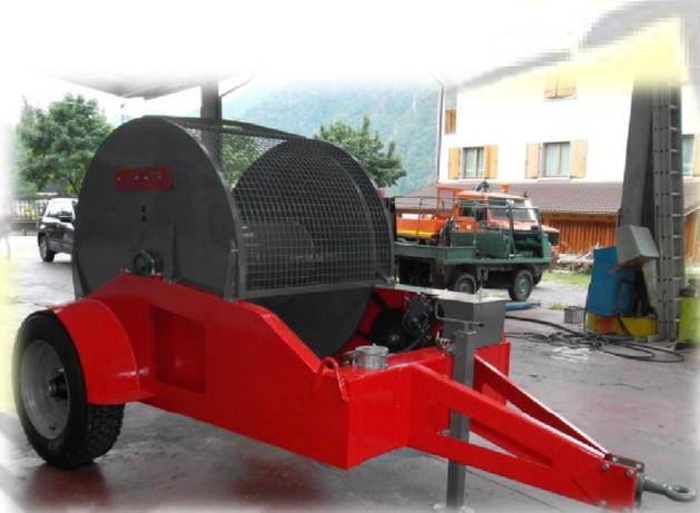
Avvolgitore oleodinamico per funi portanti di teleferiche, rotazione motorizzata della bobina oraria e antioraria.
