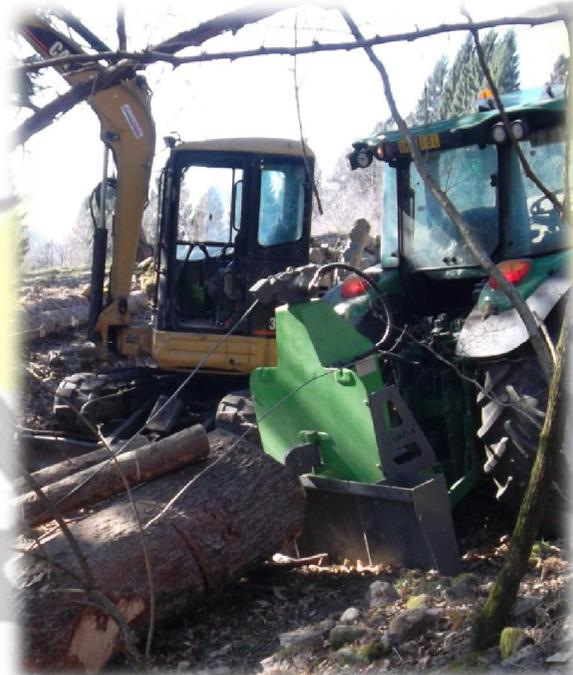
Verricello oleodinamico professionale radiocomandato a due velocità con rilascio controllato della fune, svolgimento fune motorizzato e folle tamburo.
